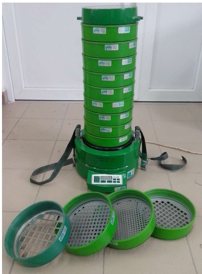
Rysunek 6. Urządzenie do wstrząsania z zestawem sit.
